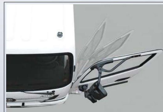
Puertas reforzadas con apertura gradual hasta los 90°
