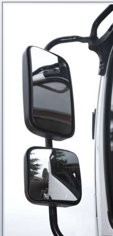
Retrovisores calefactables operados electrónicamente
