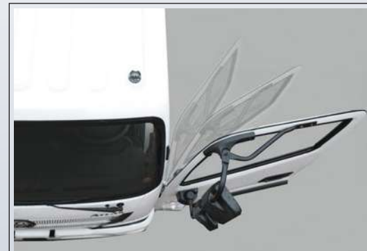
Puertas reforzadas con apertura gradual hasta los 90°
